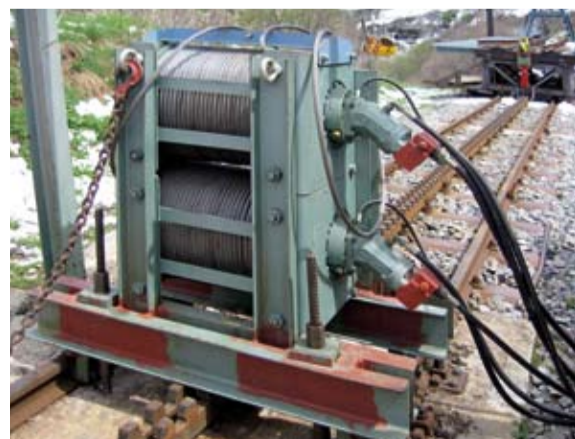
Die HK-Winden werden zum Auf- und Abbau auf die Schienen positioniert (Bild links) und ziehen die tonnenschweren Brückenteile in die gewünschte Stellung (Bild rechts)
