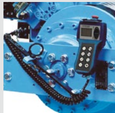
Kabelfernbedienung zur Steuerung der Winde
